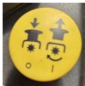
Spínač vývodového hřídele
